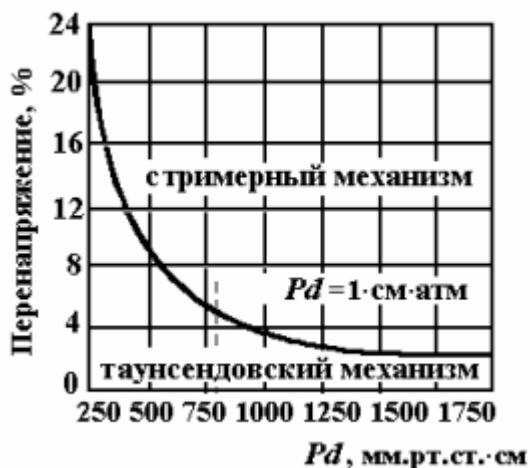
Рис. 1-10-4. Области таунсендовского и стримерного разрядов. С увеличением Pd растет число электронов в лавине, и поэтому необходимо меньшее перенапряжение.
