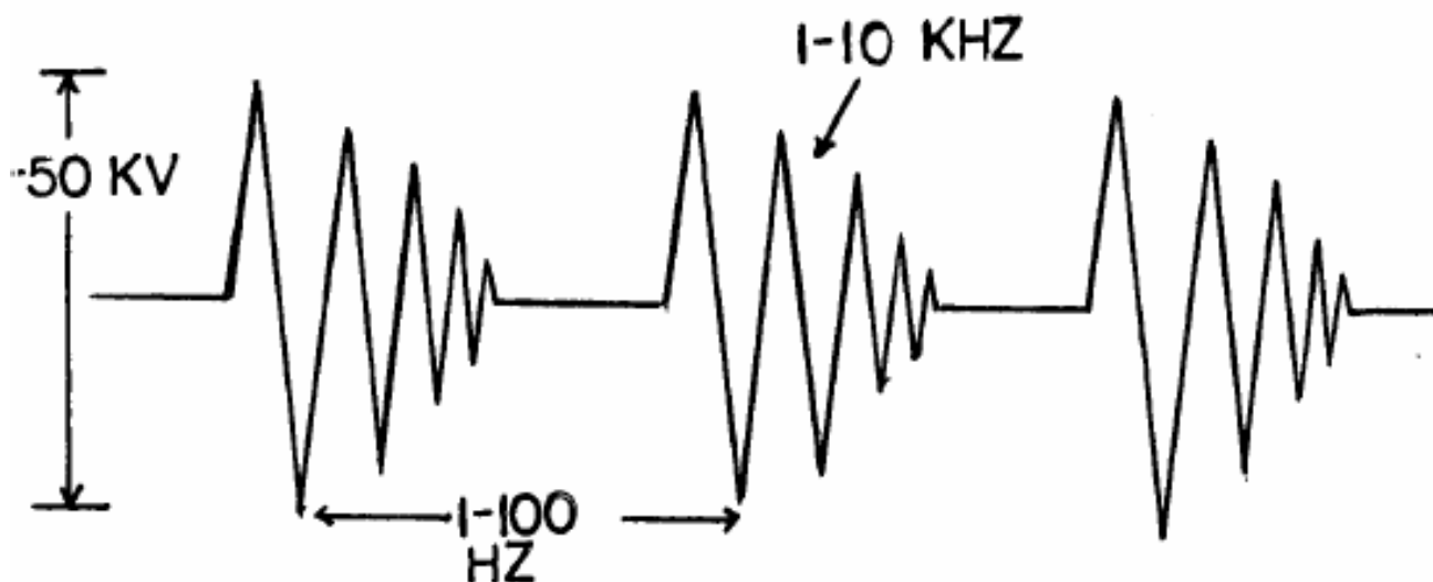
Рис. 1-5-1. Оциллограмма сигнала с генератора в установке Кирлиана С.Д.
