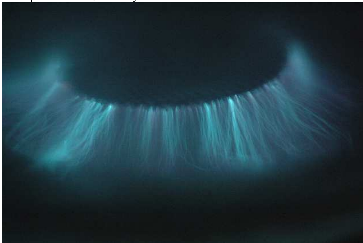
Рис. 1-8-9. Барьерный разряд в атмосфере аргона на влажном диэлектрике.
